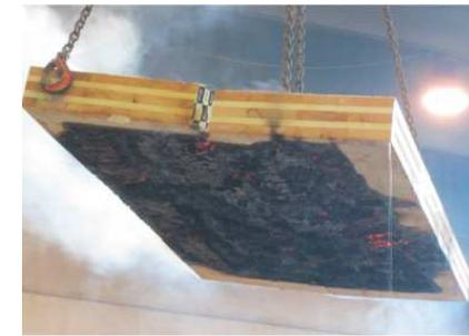
TEST SU SOLAIO CARICATO CON CONFIGURAZIONE REALE PROGETTO
